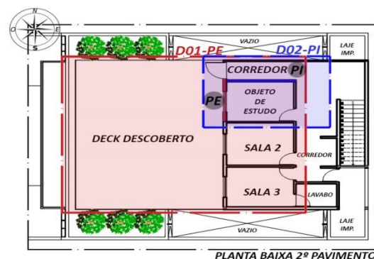
Figura 6 – Planta Baixa 2º pavimento do edifício: em destaque as paredes avaliadas, PE (vermelha) e PI (azul).
