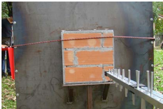
figura 5: medição CF-4000 Alvenaria de blocos cerâmicos não estruturais
