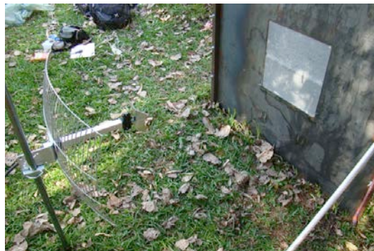
figura 6: medição final MM-2420 Alvenaria de blocos de concreto
