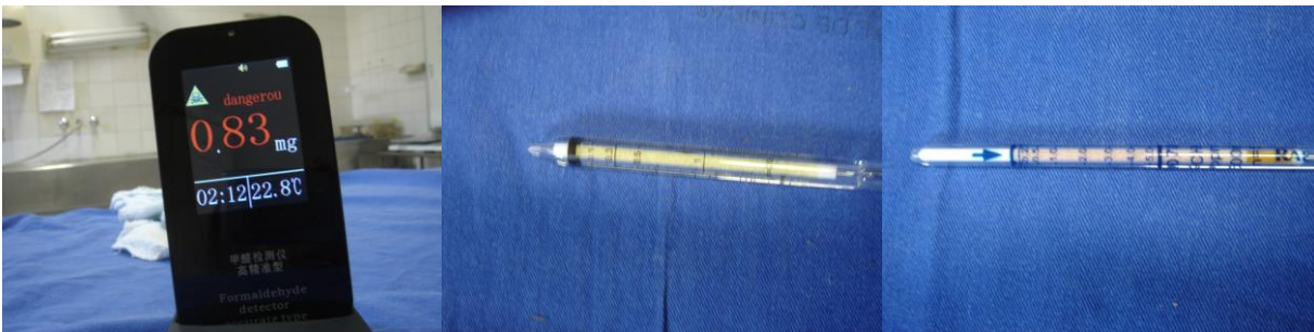
Figura 3- Resultado da medição de formaldeído no laboratório de anatomia patológica com detector eletroquímico, e com tubos colorimétricos
