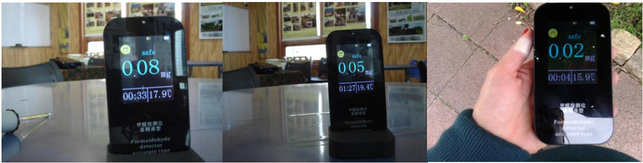
Figura 2 – Medidas no escritório verde com as janelas fechadas, abertas e no exterior
