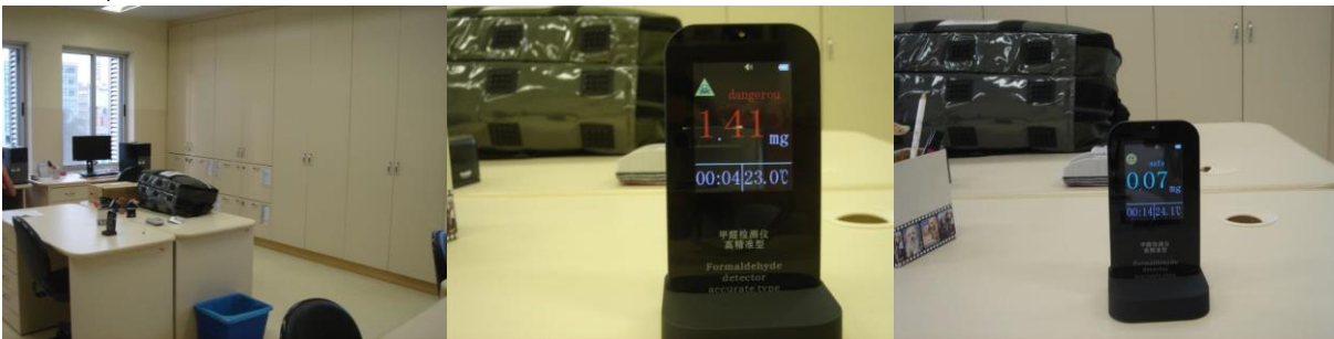
Figura 4 - Medição da sala administrativa do SCIH antes e após a abertura das janelas.
