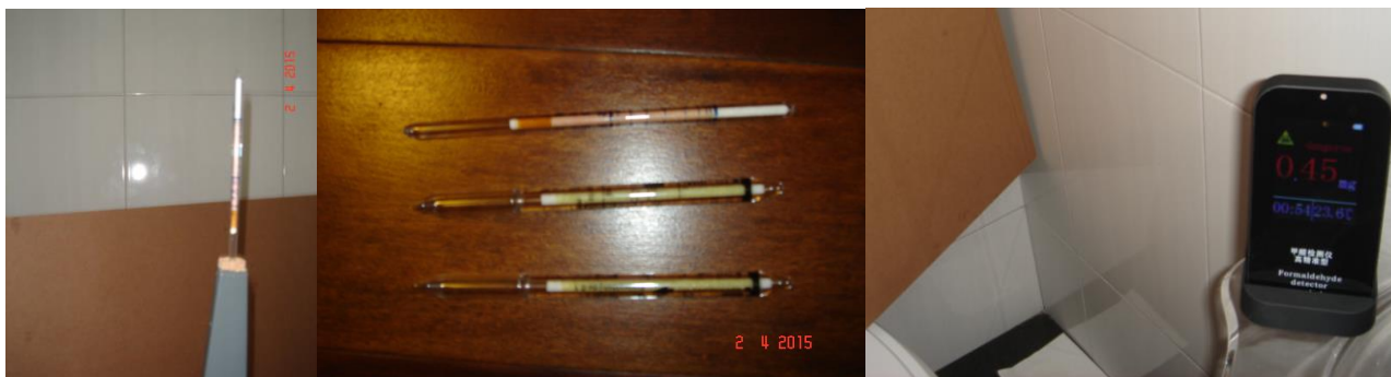
Figura 6 – Resultado das medições com tubos colorimétricos e eletroquímica no lavabo onde foi colocado uma chapa de MDF cru
