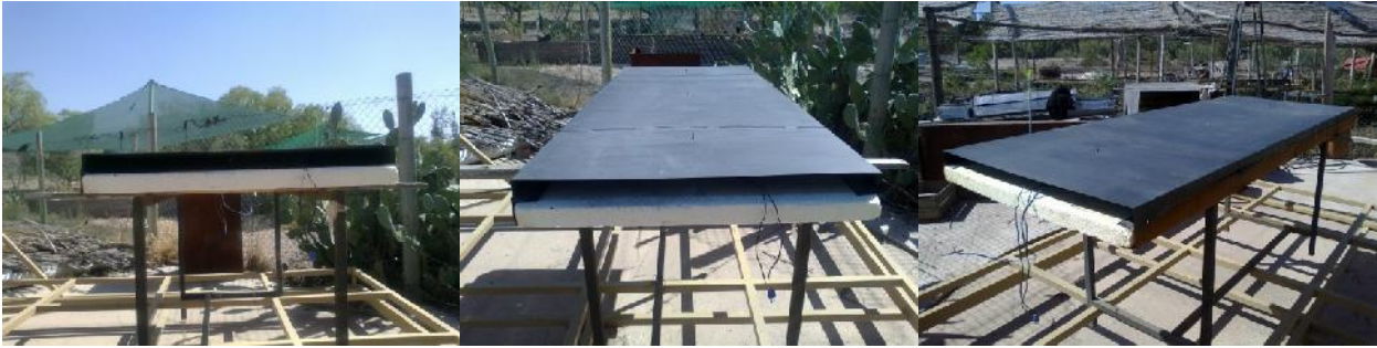
Fig. 4: Imágenes del prototipo de experimentación de un sistema de enfriamiento radiante pasivo.
