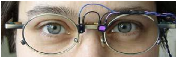
Figura 4 - LuxBlick - Dois sensores são fixados na armação de óculos. Fonte: Hubalek, Zoschg e Schierz (2005).
