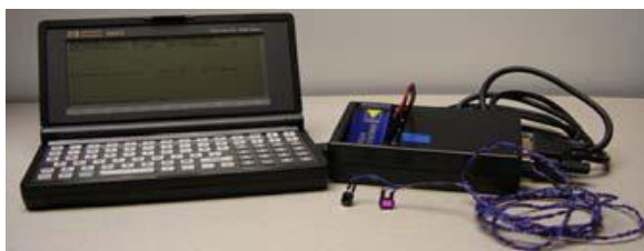
Figura 5 - Unidade de controle e minicomputador usados no dispositivo. Fonte: Hubalek, Zoschg e Schierz (2005).
