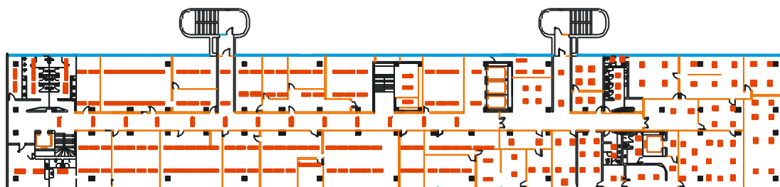
Figura 5 - Planta de paginação de luminárias do MPS.
