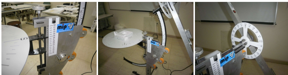
Figura 16. Regulagem de altura da mesa, cremalheira e marcador de horas.
