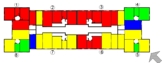
Figura 20: escala cromática de velocidades médias no estudo de caso 2 para vento incidente 135^\circ .
