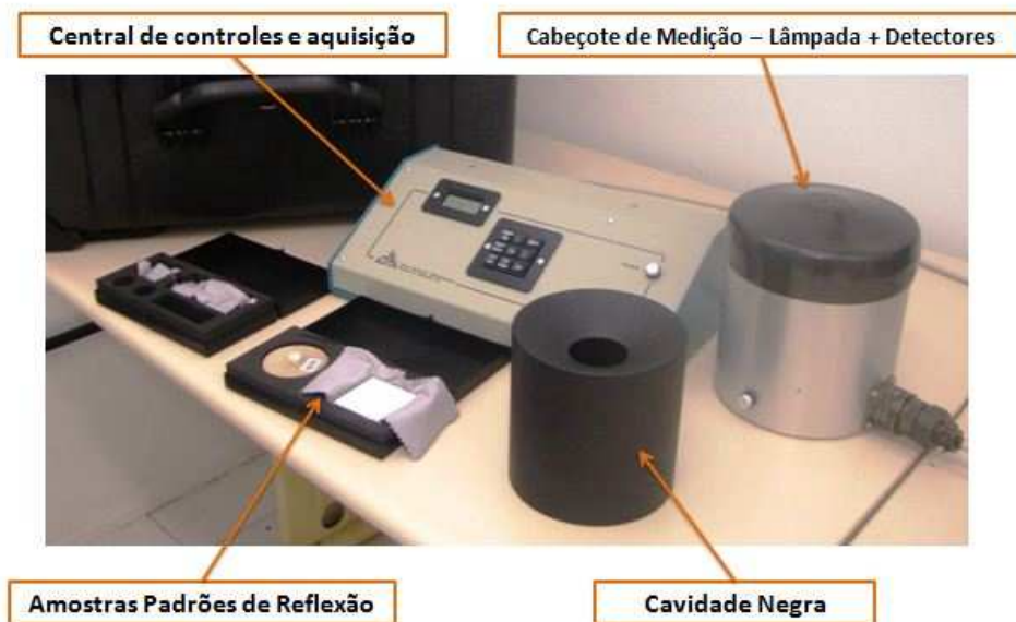
Figura 4. Componentes do refletômetro solar.
