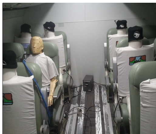
Figura 2. Vista do mock-up com manequins aquecidos simulando pessoas
