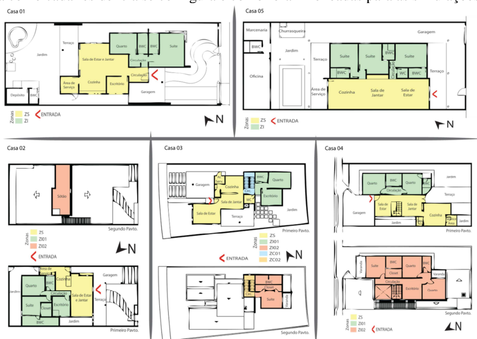
Figura 1 – Plantas baixas das residências com suas respectivas zonas e orientações.
