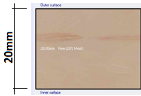
Figura 18. Seção esquemática da parede de madeira modelada no DesignBuilder.
