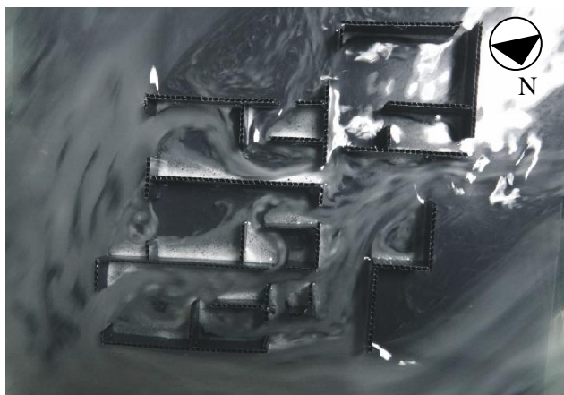
Figura 9 - Comportamento do Escoamento do vento NE, sem a representação por meio de setas direcionais. Pavimento Superior.
