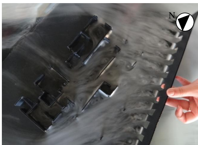
Figura 19 - Comportamento do Escoamento do vento SE com o muro, sem a representação por meio de setas direcionais.. Pavimento Térreo.
