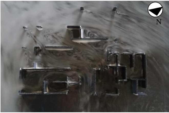
Figura 13 - Comportamento do Escoamento do vento SE, sem a representação por meio de setas direcionais. Pavimento Térreo.
