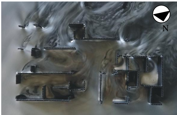
Figura 5 - Comportamento do Escoamento do vento NE, sem a representação por meio de setas direcionais. Pavimento Térreo.
