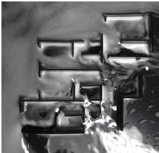
Figura 15 - Comportamento do Escoamento do vento SE, sem a representação por meio de setas direcionais. Pavimento Superior.
