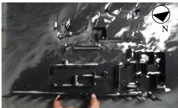
Figura 17 - Comportamento do Escoamento do vento NE com o muro, sem a representação por meio de setas direcionais. Pavimento Térreo.
