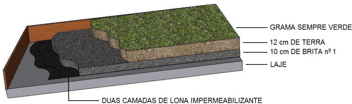
Figura 4 – Detalhe das camadas utilizadas na cobertura vegetal.
