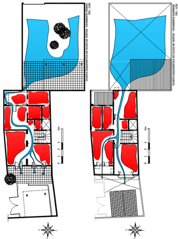
Figura 5 – Fluxo do vento no interior da edificação – Situação atual (Fonte: Larissa Amaral)
