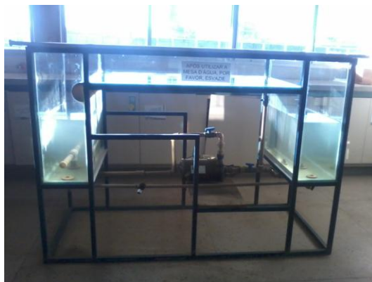
Figura 04 - Equipamento mesa d' água utilizado para simulação da ventilação natural. Fonte: Arquivo pessoal, 2013.
