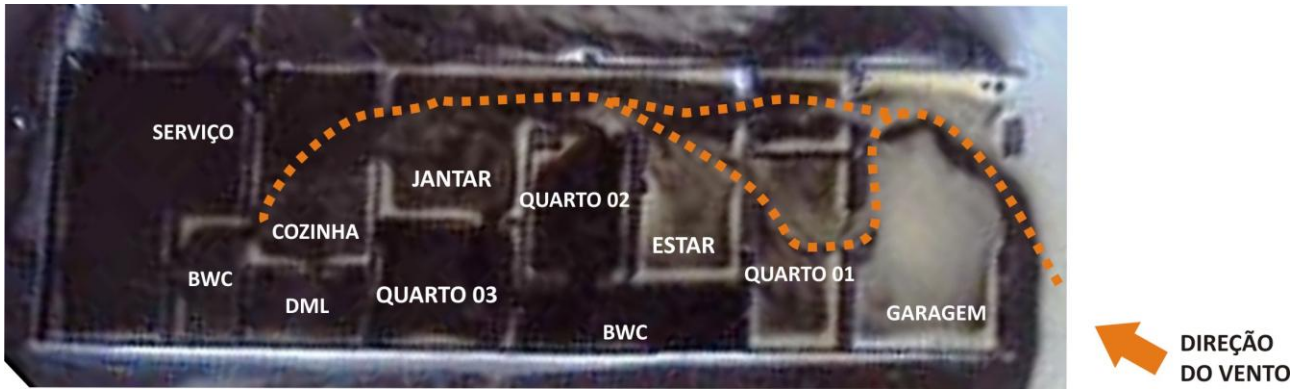
Figura 05 - Ensaio na mesa d'água da habitação em planta baixa com incidência do vento sudeste.
