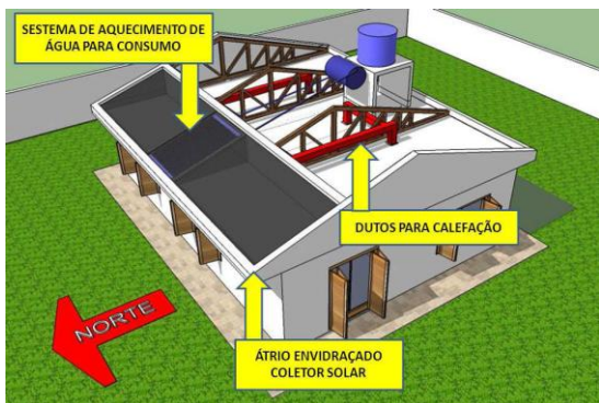
Figura 1 – Disposição do sistema combinado proposto na residência.
