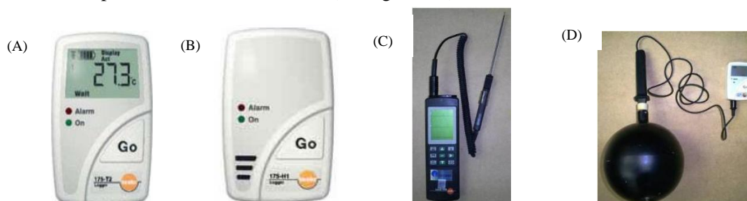
Figura 3 - Equipamentos utilizados na medição das variáveis ambientais: (A) registrador de temperatura; (B) registrador de temperatura e umidade; (C) registrador multi-função e sensor de esfera quente; (D) sensor de temperatura inserido no globo.
