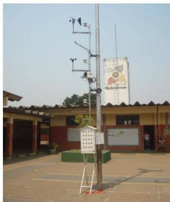
Figura 3 - Abrigo e estação meteorológica instalados no pátio central da escola estadual.
