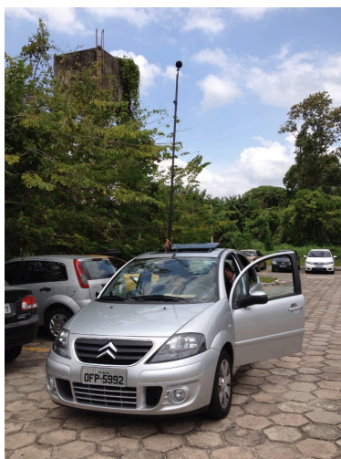
Figura 1 – Adaptação do sonômetro no momento dos testes para a medição de campo.
