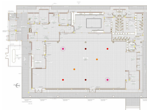
Figura 9. Pontos de medição em marrom, vermelho e laranja e de fonte sonora em rosa, para medição de TR e Inteligibilidade no interior do Restaurante.
