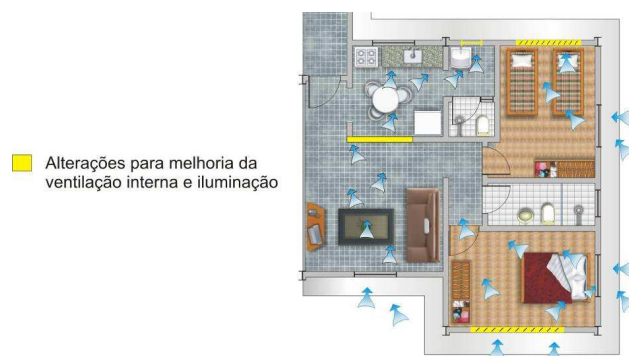
Figura 17 – Estratégias de ventilação cruzada – planta
