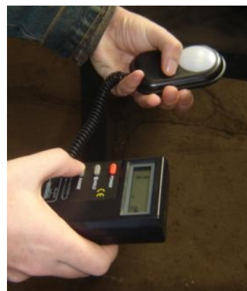
Figura 2: Luxímetro LD-200 da Instrutherm
