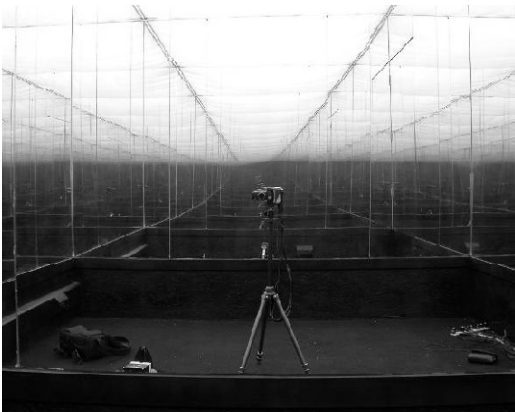
Figura 6 - Céu artificial tipo “caixa de espelhos” do LabCon/ARQ/UFSC
