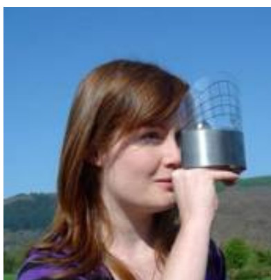
Figura 3 (a, b) - Equipamento de visualização da trajetória solar específica de um lugar Solar Site Selector (acesso: http://www.solardesign.co.uk/pw-solar.php )
