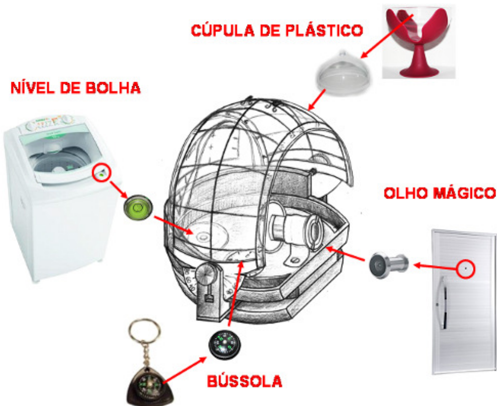
Figura 7 – Modelo final do equipamento com os componentes alternativos utilizados na sua construção.
