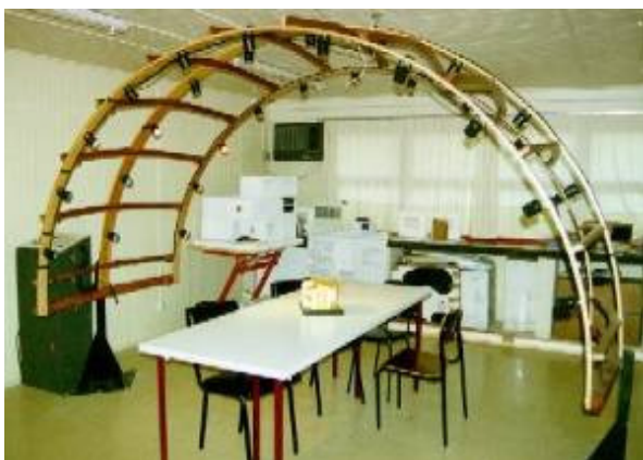
Figura 1 - Simulador da trajetória solar para modelos físicos - Solarscópio (LabCon/ARQ – UFSC)
