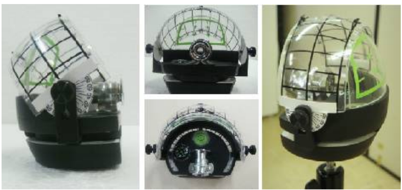
Figura 8 – Fotos lateral, frontal e superior do equipamento, com a JCP em verde e trajetórias solares demarcadas por linhas pretas
