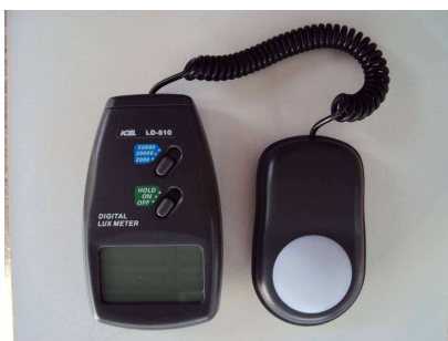
Figura 2 - Luxímetro Digital Portátil
