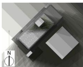
Figura 7 – Simulação da incidência do sol na cobertura realizada no Ecotect (versão educacional). Essa imagem serviu para decidir onde seriam colocados os painéis fotovoltaicos.
