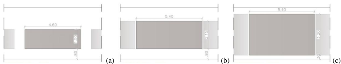
Figura 7 – Representações de fachada do caso de referência para PAFT de (a) 36%, (b) 60% e (c) 90%.
