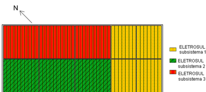
Figura 3 - Vista geral do sistema fotovoltaico de 11,97 kWp da ELETROSUL. Figura 4 - Distribuição dos módulos em subsistemas.
