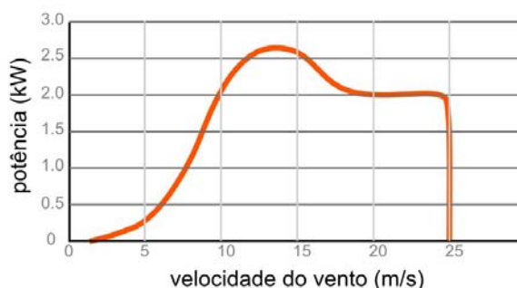
Figura 8. Curva de potência do Skystream 3.7 em função da velocidade do vento.
