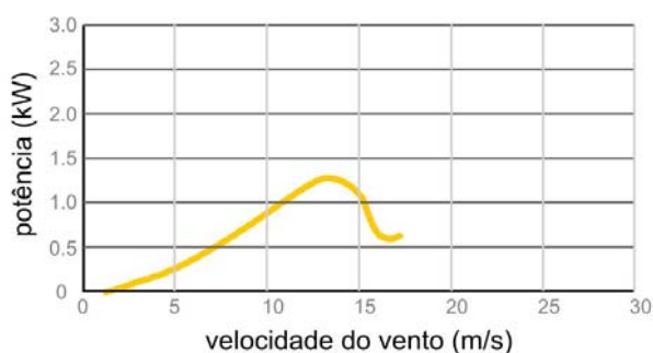
Figura 6. Curva de potência do Gerar 246 em função da velocidade do vento.
