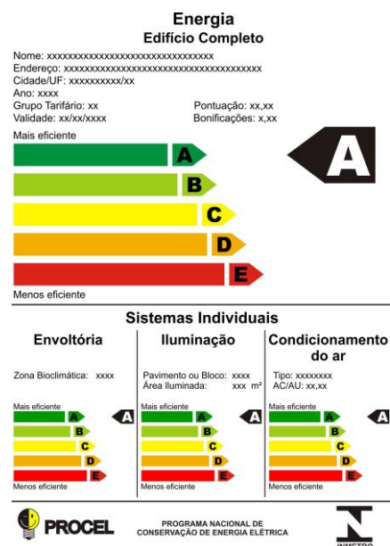
Figura 1 - Modelo da ENCE, neste caso, apresentando níveis de eficiência A. FONTE: BRASIL, 2010b.
