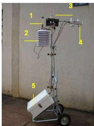
Figura 7 – Estação meteorológica. Equipamentos numerados listados na Tabela 1. Sensores fixos na altura de 1,5 m. Fonte: Arquivo da autora, 2009.
