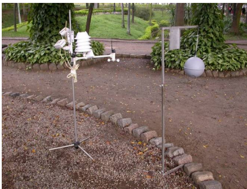
Figura 8 - Estação meteorológica presa ao tripé de base articulada e termômetro de globo pendurado no tripé de base de pontas fixas (as pontas estão sob as pedras, para dar maior estabilidade)
