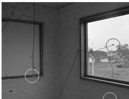
Figura 7 –Termopares temperaturas superficiais.
