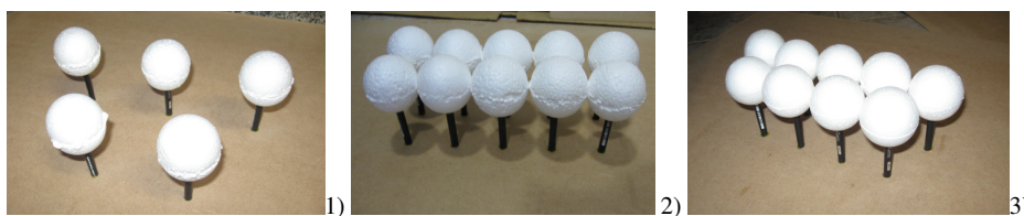
Figura 3 – Foto com o modelo reduzido: 1) copas distantes com duas linhas em ziguezague; 2) copas tocando-se com duas linhas paralelas, e 3) copas entrelaçando-se com duas linhas em ziguezague
