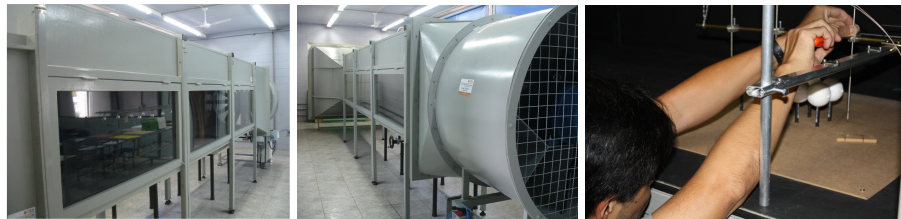
Figura 5 – a) Túnel de vento e b) Instalação do anemômetro de fio quente (Autor: Edson Matsumoto).
