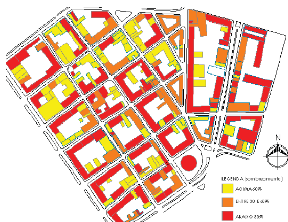
Figura 14 – Efeito do sombreamento da forma urbana no plano das coberturas, na opção de quadras perimetrais.
