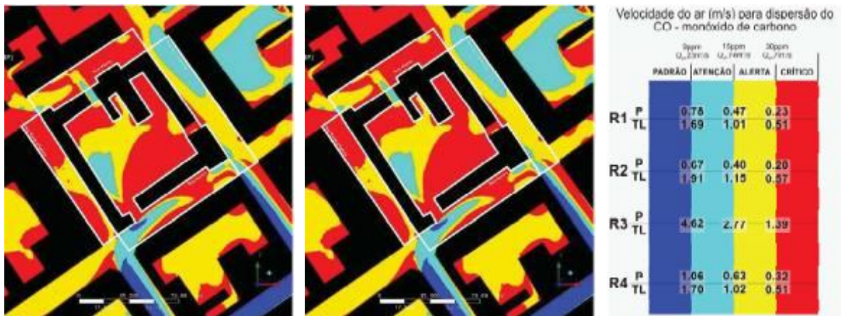
Figura 8 - desempenho da qualidade do ar na quadra de referência, no nível do pedestre (1,5 metros), nas duas opções de ocupação: quadra perimetral (a esquerda) e quadra aberta (a direita).
