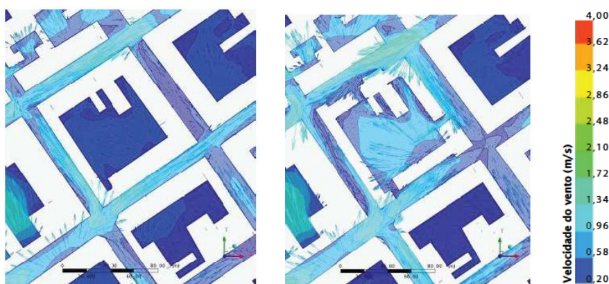
Figura 7 - simulações de ventilação urbana ao redor e no interior da quadra de referência, dia a situação de verão, no nível do pedestre (1,5 metros), nas duas opções de ocupação: quadra perimetral (à esquerda) e quadra aberta (à direita).
