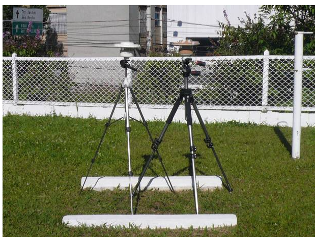
Figura 8 - Abrigos montados sobre tripé, a 1,1m do solo, com e sem revestimentos, para o procedimento de aferição no 5º DISME/INMET. Fonte: Hirashima (2010).
