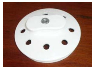
Figura 3 – Furação da base do abrigo e encaixe da porca sextavada de 1/4". Fonte: Hirashima (2010).
