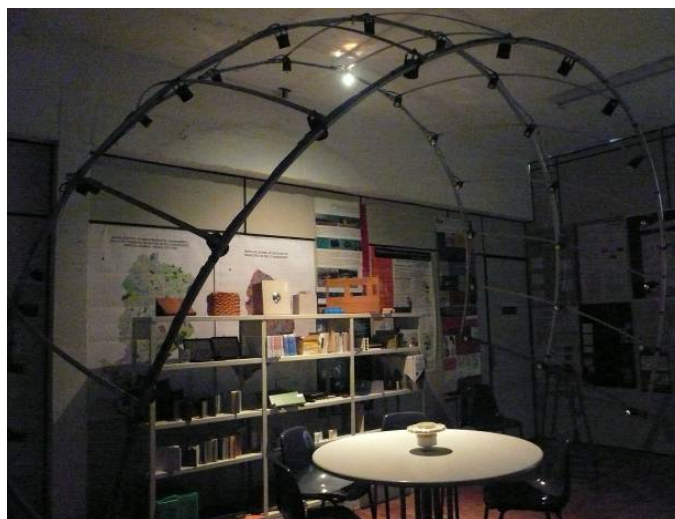
Figura 7 - Teste do abrigo com a peça antiinfiltração usada como pára-sol, realizado no heliodon do LABCON/UFMG. Fonte: Hirashima (2010).
