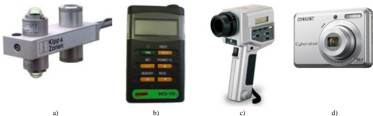
Figura 1 – Instrumentos usados na pesquisa: a) radiômetro, b) medidor de energia solar, c) luminômetro, d) câmera fotográfica.
