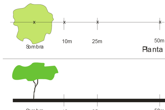
Figura 4. Posicionamento dos equipamentos de medição. Fonte: Abreu (2008)
