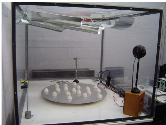
Figura 1 – Câmara reverberante em escala.
