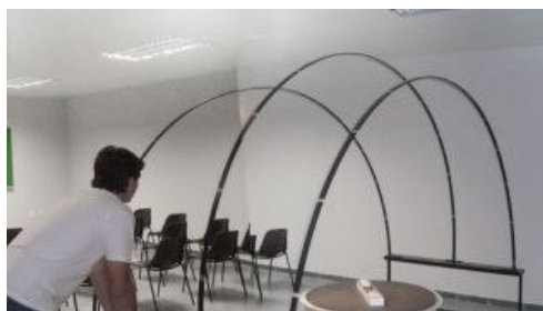
Figura 11. Modelo Heliodon de 3 arcos fixos e mesa móvel.
