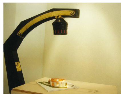
Figura 16. Heliodon de Haste com “régua de dias” ou calendário. Fonte:
