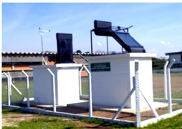
Figura 1 – Chaminé convencional (vertical) e chaminé solar (inclinada) localizadas na cidade de São Carlos – SP
