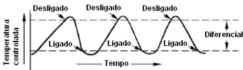
Figura 1 – Exemplo típico do algoritmo de controle Liga-Desliga com diferencial. Adaptado de ASHRAE Fundamentals (2001)
