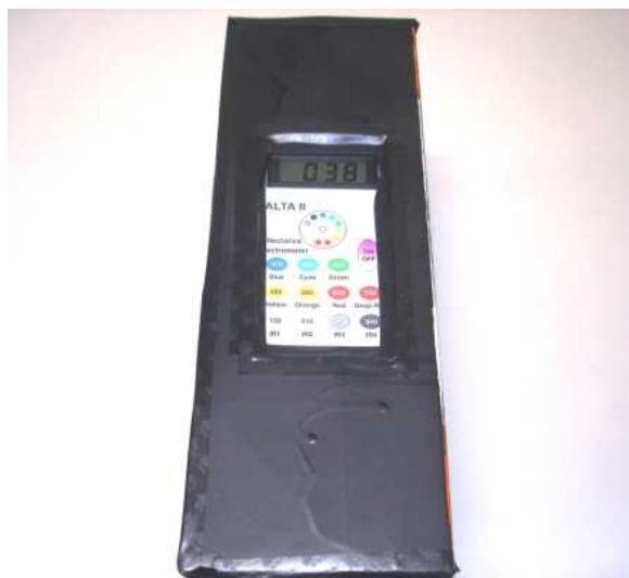
Figura 4. Abertura na câmara, deixando exposta a frente do espectrômetro.
