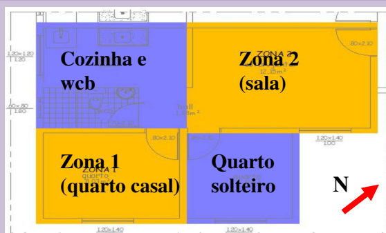
Figura 3: Divisão das quatro zonas térmicas, pavimento tipo, para simulação computacional.
