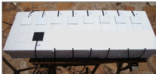
Figura 6 – Placa de isopor com amostras expostas ao sol.
