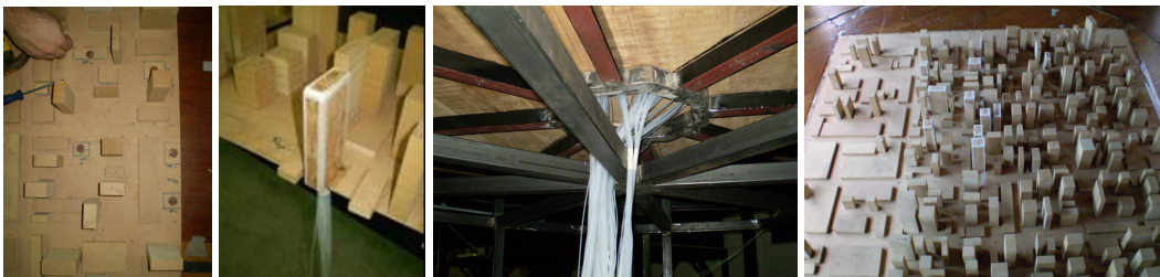
Figura 6 – Preparação do modelo com as tomadas de pressão: escala 1:500 (PRATA-SHIMOMURA, 2008).
