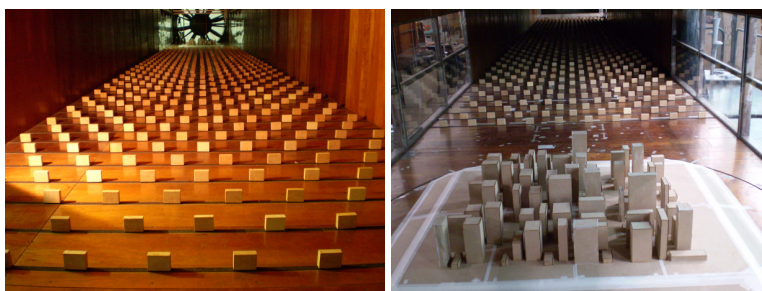
Figura 1 – Exemplo de elementos de rugosidade colocados no piso do túnel de vento ( PRATA SHIMOMURA, 2010).
