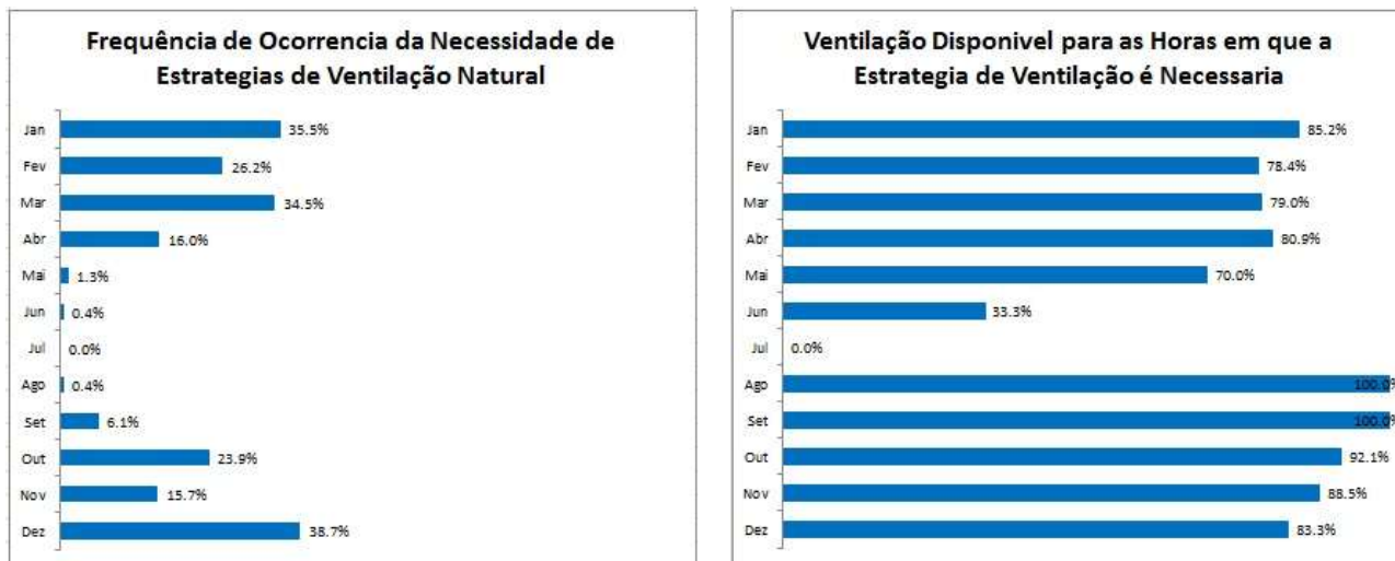
Figura 17 - (a) Frequência das estratégias de ventilação natural em geral, (b) disponibilidade de ventilação natural para as horas em que esta é necessária.
