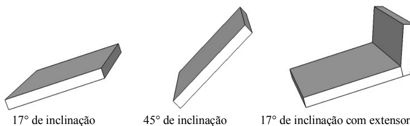
Figura 2 – Variação no ângulo de inclinação da chaminé
