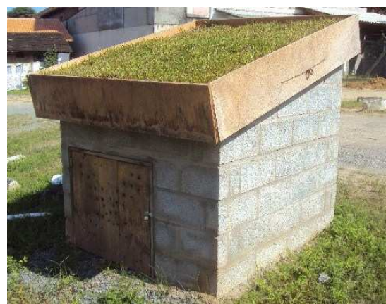
Figura 08 - Célula-teste 06. Laje com isolamento térmico + cobertura vegetal
