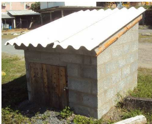
Figura 03 - Célula-teste 01. Laje sem isolamento térmico + telha de fibrocimento
