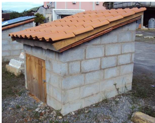
Figura 04 - Célula-teste 02. Laje sem isolamento térmico + telha cerâmica
